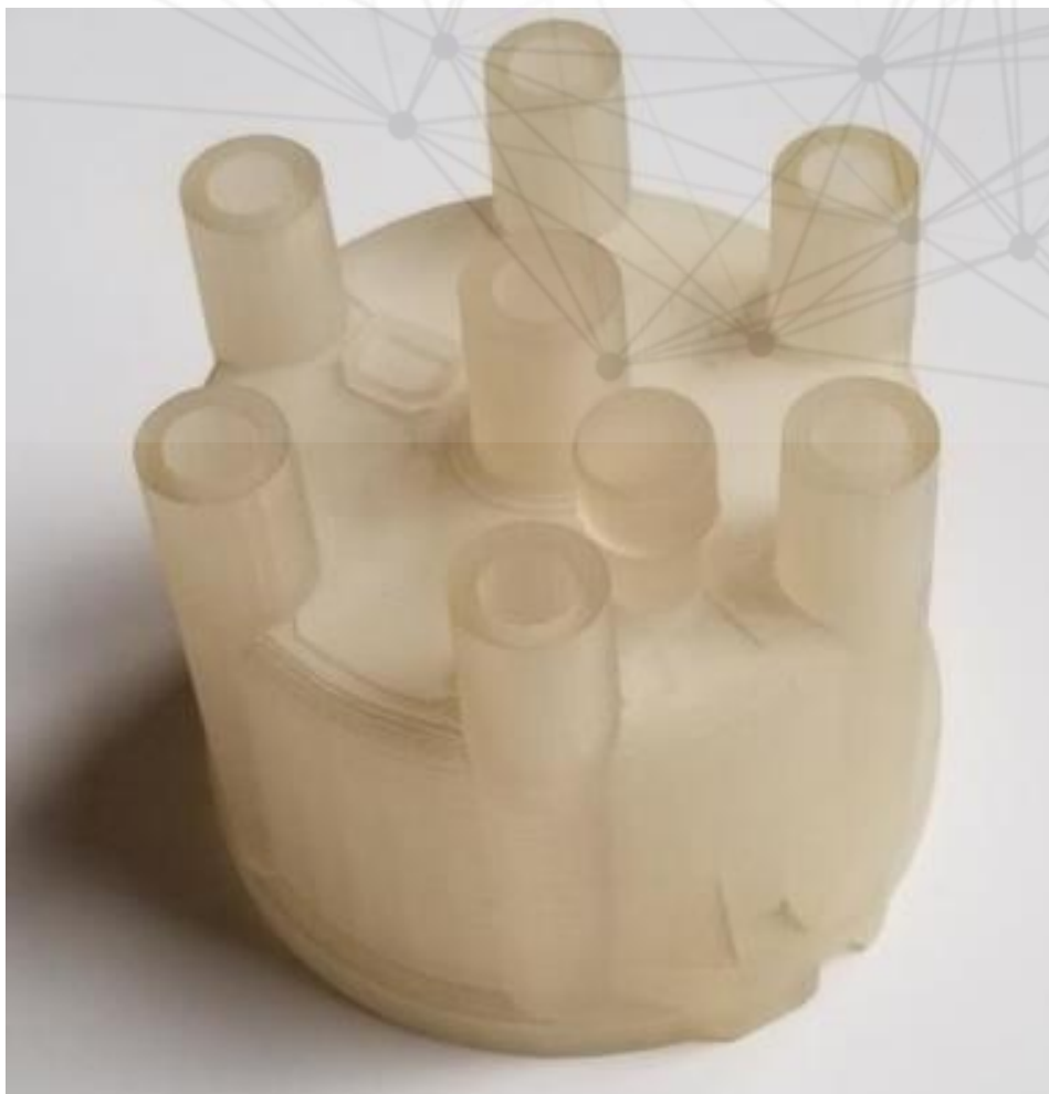
■ Рисунок 1 - Прототип автомобильной распределительной крышки, изготовленной в 1987 г. с использованием машины для фотополимеризации
