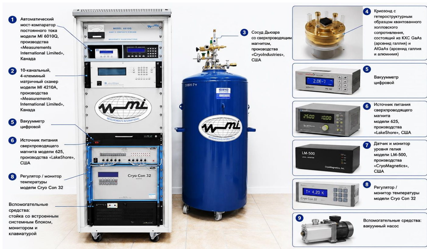
Рисунок 2 - Состав Государственного первичного эталона электрического сопротивления на основе КЭХ
