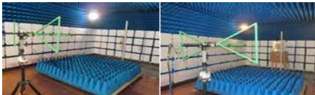
Рис. 6. Измерения на расстоянии 3 м: (а) в свободном пространстве, (б) с имитацией ИО
