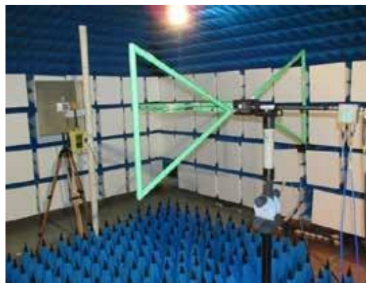
Рис. 10. Испытательная установка для термогигрометра
