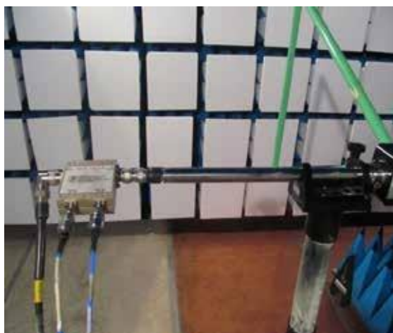
Рис. 8. Измерение чистой мощности на входе антенны для расчетного метода
