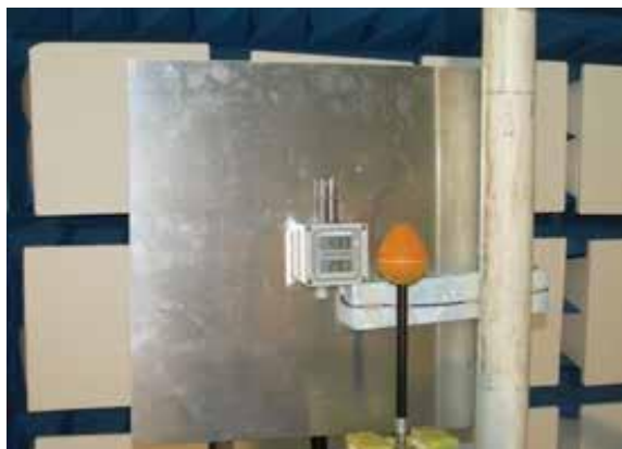
9. Термогигрометр, использованный в качестве ИО.
