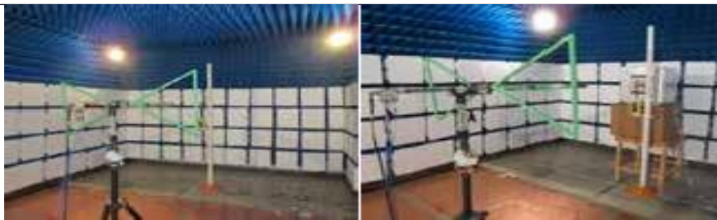
Рис. 7. Измерения на расстоянии 1 м: (а) в свободном пространстве, (б) с имитацией ИО
